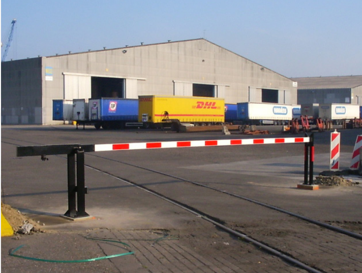
Handbediende slagboom met vaste steunpaal
